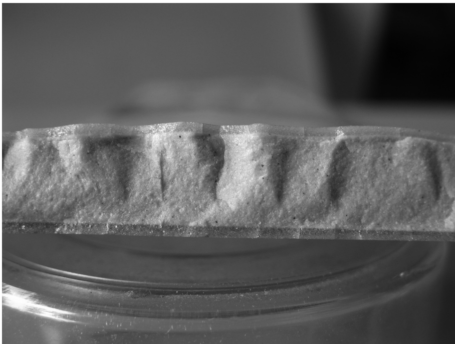
圖21 燒成圖20標本以後的釉、胎的截面 釉層厚度約0.6-0.7毫米
