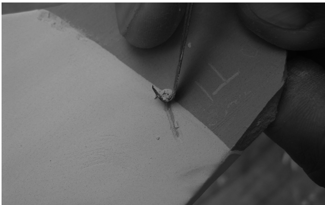
圖13 刮削素燒器釉層的情景
