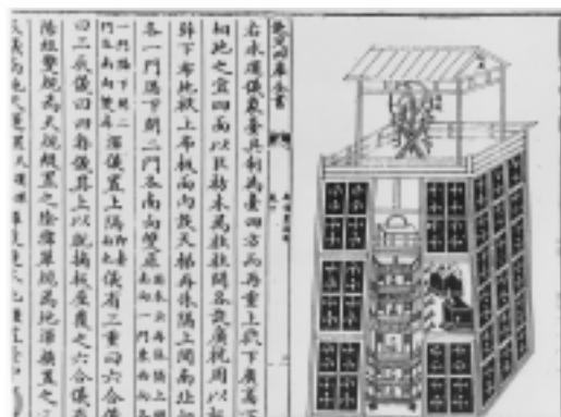
圖 169-3 〈水運儀象台〉 《新儀象法要》卷下
